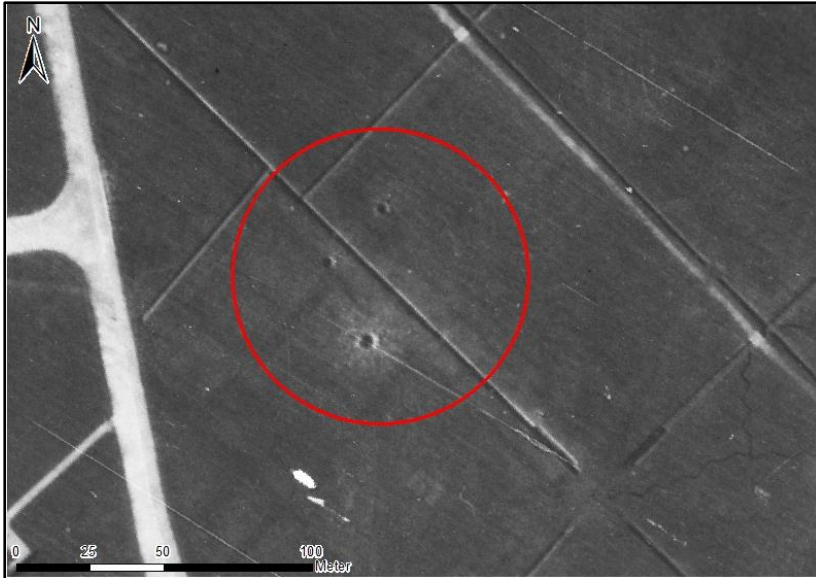
Figuur B2-2: Voorbeeld van een afworp met drie bommen, met een ongelijkmatige driehoek als kraterpatroon. De twee kleinere kraters van de 250 lb.-bommen liggen dicht bij elkaar, terwijl de grotere krater van de 500 lb.-bom op grotere afstand van deze twee kraters ligt.
